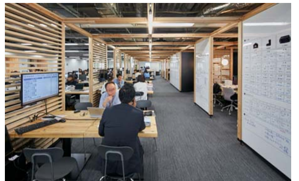
オフィス内のデスク天板はスギの端材を利用した中空パネル。
