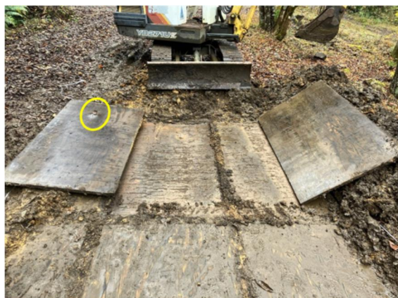
図-5 2024 年 11 月に掘り出した構造用合板（黄色丸で囲った部分が碎石がめり込んだ跡）
