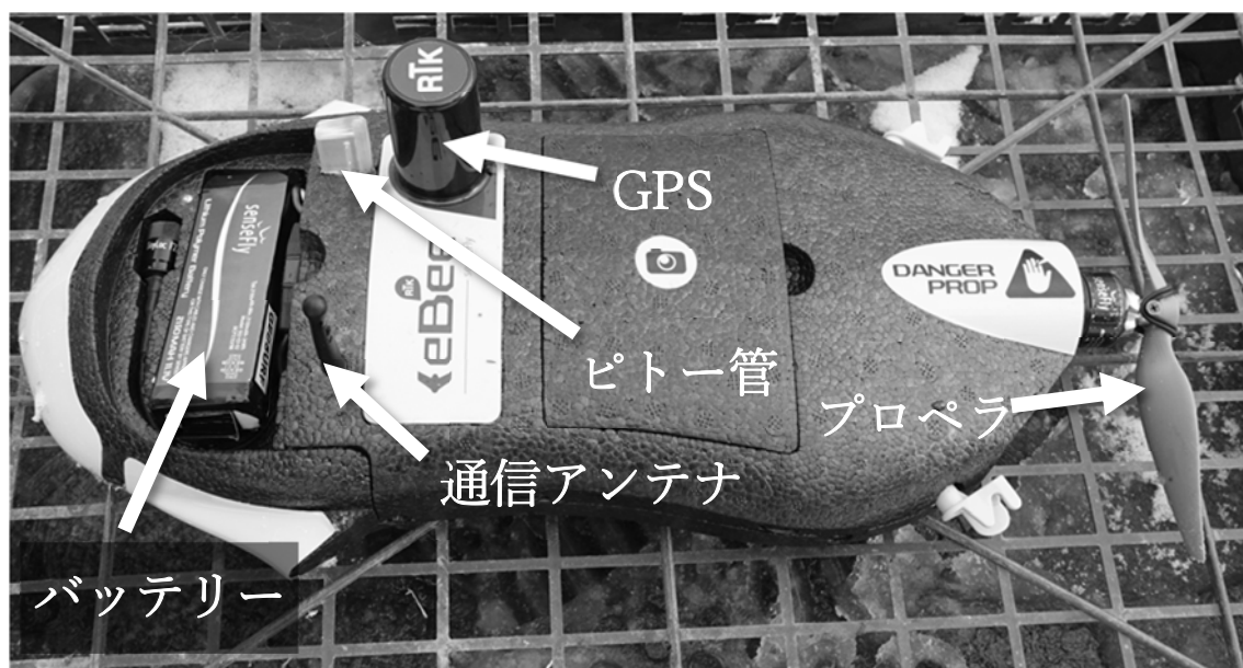
図-1 固定翼型 UAV (eBee、senseFly 社製、スイス) 上図：全体、下図：羽を外した状態
