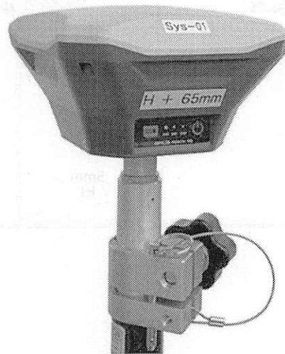
図一 3 使用した GNSS 受信機 (Reach RS, Emlid 社)
