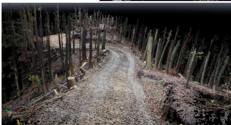
図-6 動画データを基として SfM により構築した作業道の三次元点群データ 上図緑点：SfM 処理過程で推定された画像撮影位置
