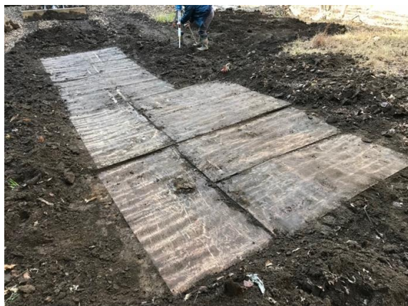
写真 2 施工1年後に回収した合板を掘り出した直後の状態（掘削深さ100mm） （左：表面の状態、右：裏側の状態）
