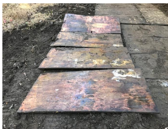
写真 2 施工1年後に回収した合板を掘り出した直後の状態（掘削深さ100mm） （左：表面の状態、右：裏側の状態）
