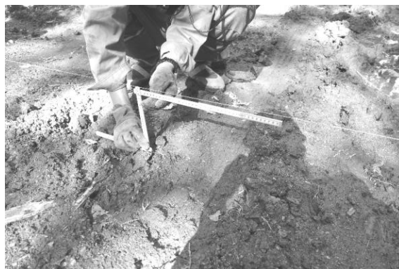
図ー2 路面高の計測
