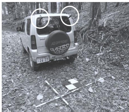
図ー1 ビデオカメラ（白色円内） を取り付けた試験車両
