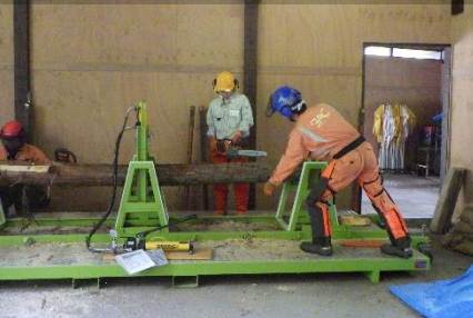
ガイドバーが材に挟まれないような鋸断の方法を習得
