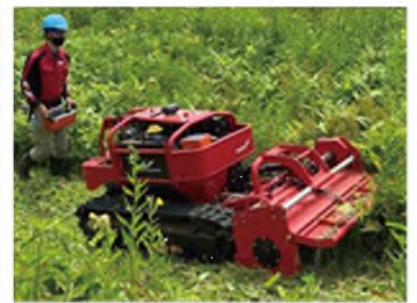
小型遠隔操作式下刈り作業機械 （写真提供：林野庁）
