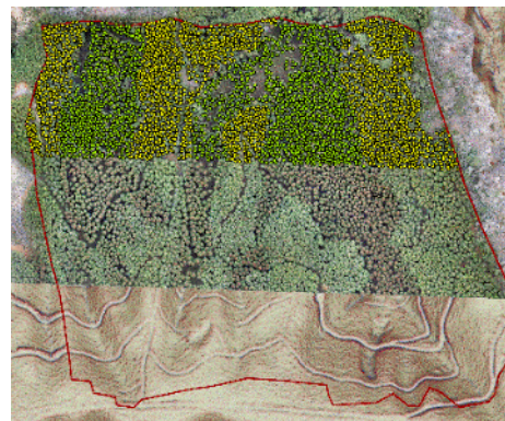
図2：UAVレーザ計測による森林現況調査 （上段：樹頂点解析図（緑：スギ、黄：ヒノキ）、中段：オルソ画像 下段：微地形表現図）
