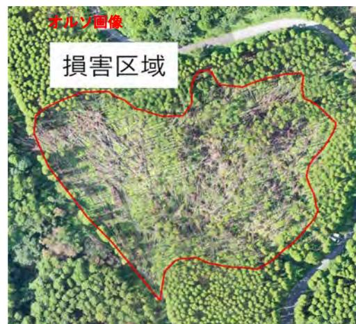
図2 UAV（ドローン）活用による風害の査定
