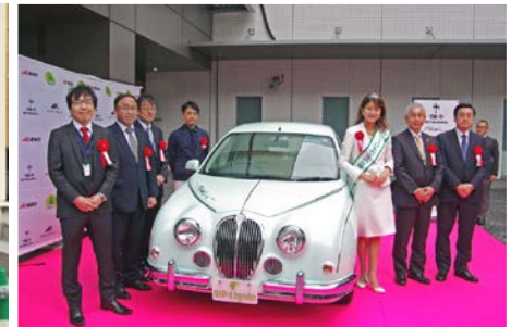
改質リグニンを含む繊維強化材をボンネットとドアトリムに用いた自動車
