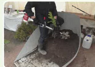
ガソリンエンジンを使用した苗木自動植栽機の開発も進められています。
