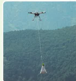
ドローンによる苗木運搬(写真: 架橋集材の低コスト化・省力化技術研究会)
