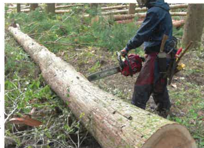
チェーンソーによる伐倒後に、その場で、枝葉を払い、必要な長さに切る「玉切り」という作業を行います。
