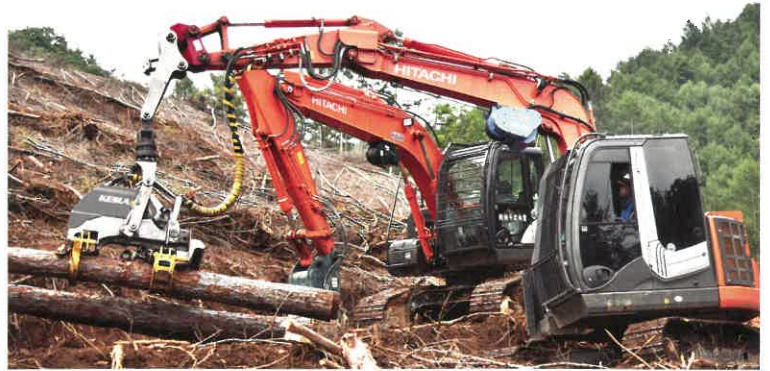
中谷さんが操作するハーベスタ。林業機械の導入で女性も男性と変わらず働ける環境になっています。
