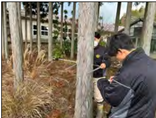
【写真】生徒が輪尺を活用して胸高直径を測定している様子
