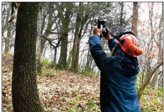
【写真】フォトグラメトリの処理のために対象木の胸高位置周囲の撮影を行う
