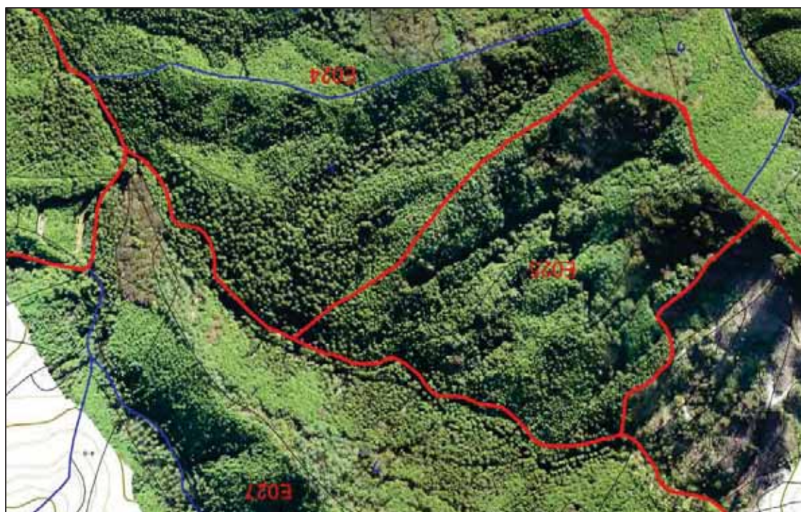
【上図】 演習林の地形図に重ねたオルソ画像。下図の演習林の立体図に対応させるために、地図の北が下になるように画像を180度回転させている。
