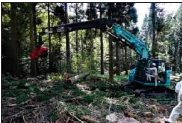
【写真】オペレーターに指導を受けながらローリンググラップルソー（高性能林業機械）を操作体験している生徒の様子
