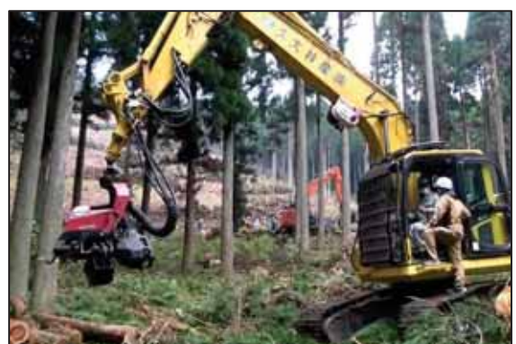
【写真】オペレーターから指導を受けながらハーベスタの操作
