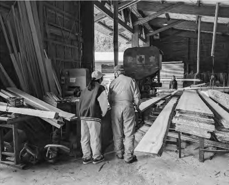
送材車付帯のご盤で丸太から挽いた板を、必要な幅に切断する作業の説明を受ける
