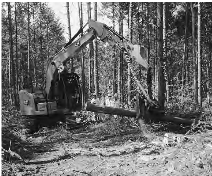
ハーベスタによる枝払い造材作業
