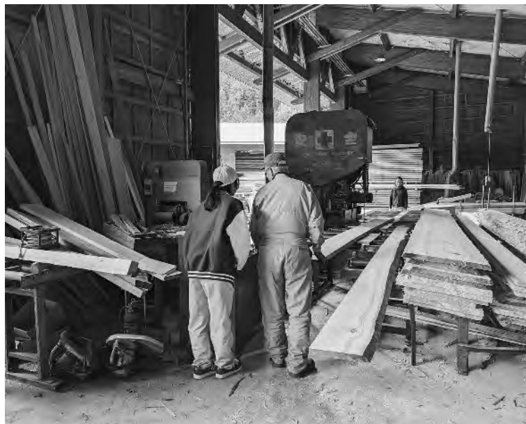
送材車付帯のこ盤で丸太から挽いた板を、必要な幅に切断する作業の説明を受ける
