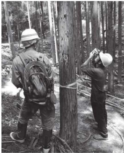
レーザ測高器を使って、樹高計測に挑戦
