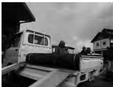
アルミブリッジとロープを各2本用いて、スギ丸太を軽トラへ積み込みました
