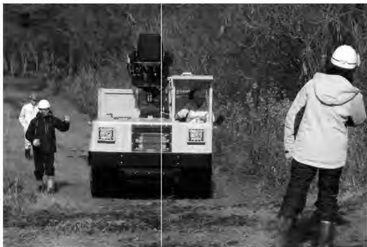
フォワーダ（重量6t、積載重量3t、時速10km）操作が一番人気があった。 運転免許もまだ持たない生徒たちだが、上手に操作していた
