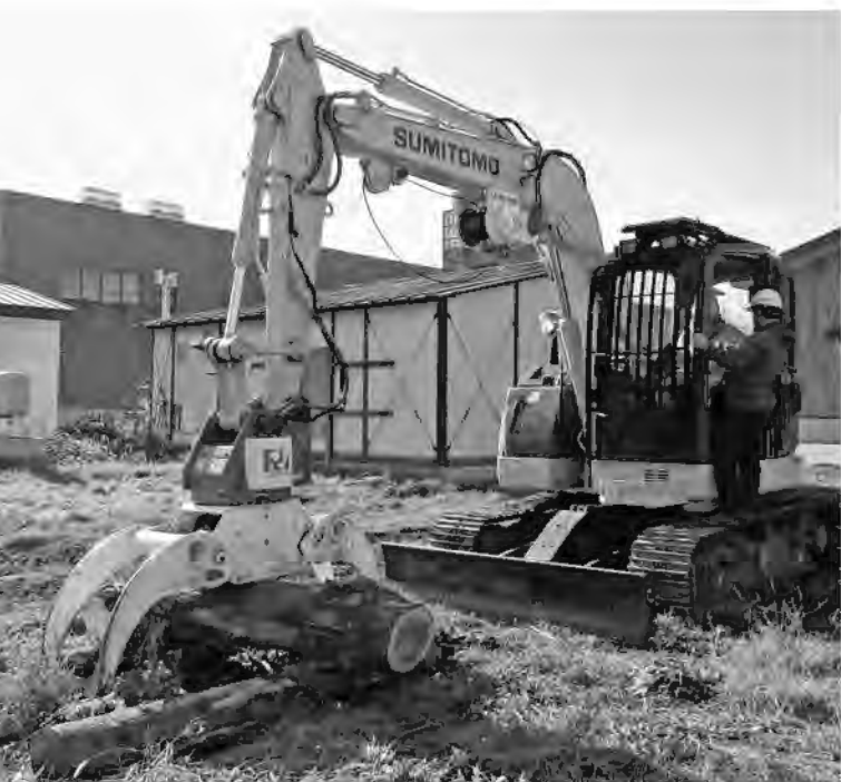
グラップル（重量8t最大開口193.5cm、最少掘径6.5cm）を操作する。「頭で考えると難しいが、慣れたら上手くなる自信がある」と生徒の声
