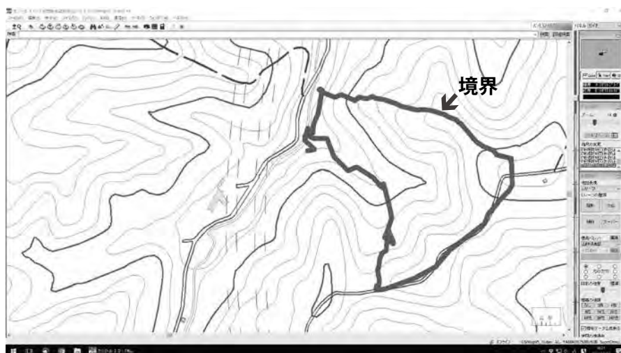
現地で調査・収集した GPS データをカシミール 3D ソフト（パソコン上）に入れ込み、地図として表示させた例（編集部作成）
