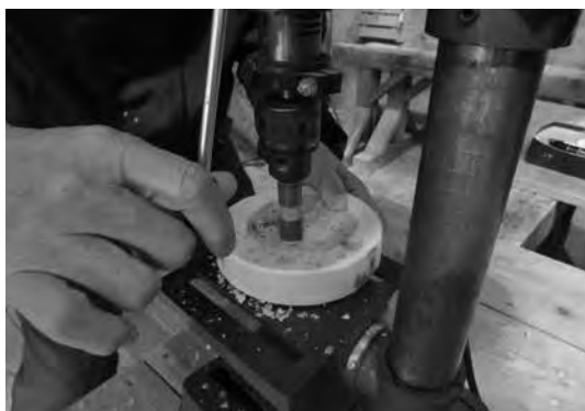
④卓上ボール盤（ドリル） でコマの穴を開ける
