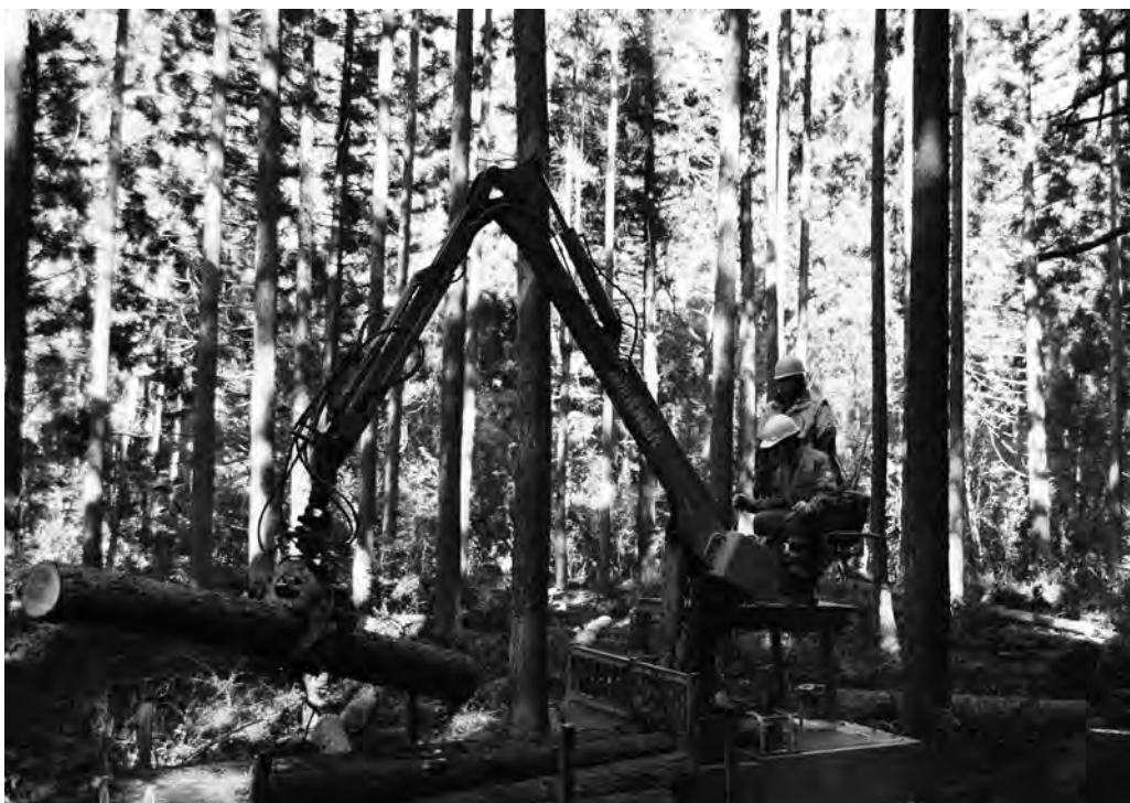
フォワーダのグラップルを使い、材の積み降ろし操作を行ったが、高い位置での作業に「怖かった」という感想も聞かれた
