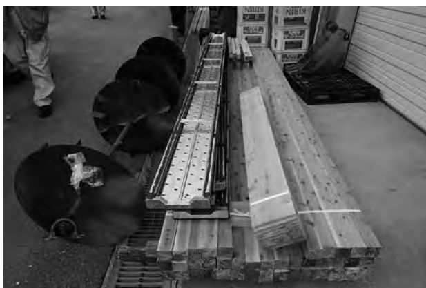
水車の材料（角材・板材・車軸ほか）
