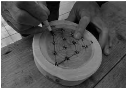
③テンプレートを置き、穴 開け位置に印を付ける
