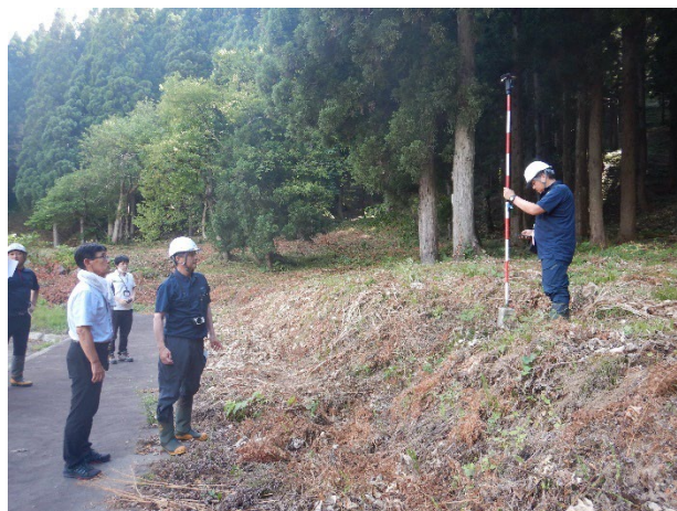
【RTK-GNSS測位法による境界明確化作業】
