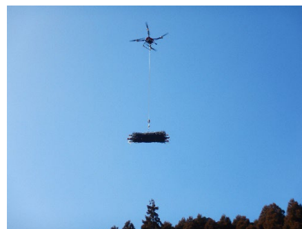
写真③ ドローンによる単木保護資材の運搬
