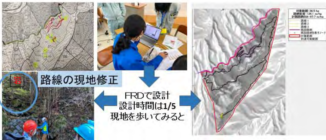
【写真】タブレット端末に表示した自動設計された線形と、現地の状況とを比較検討した
