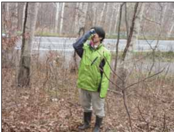
【写真】バーテックス5を操作し樹高を測定する
