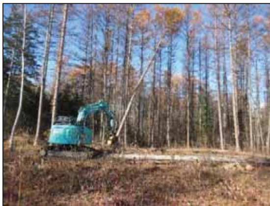
【写真】実習で使用した ICT ハーベスタ（PONSSE）
