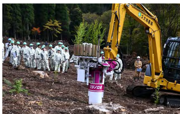
【写真】開発中の植栽機械によるコンテナ苗（スギ）の植栽を見学
