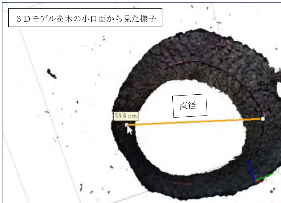
【画像3】3Dモデルを回転させて上からのぞき込んだところ胸高位置引いた直線が直径を示している (数値は 59.9 cm と表示されている)
