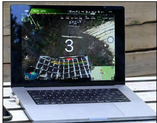
【写真】PCのモニターに送信されたドローンが撮影した治山施設のライブ映像
