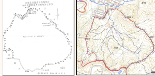
50年以上前に作成した境界線図(左)とQGISで作成した境界線図(右)
