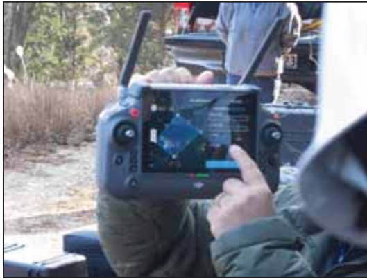
【写真】外部講師がドローンを飛ばすにあたり、コントロール画面を見せながら自動飛行ルート設定を説明する様子
