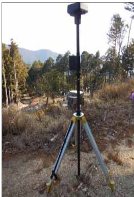
【写真】設置された RTK 基地局。ドローンへリアルタイムに補正データを送り、cm レベルの測位精度を実現
