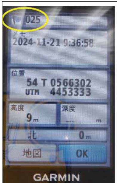
【写真】ハンディ GPS 液晶画面。樹木番号「025」の測位データが記録される
