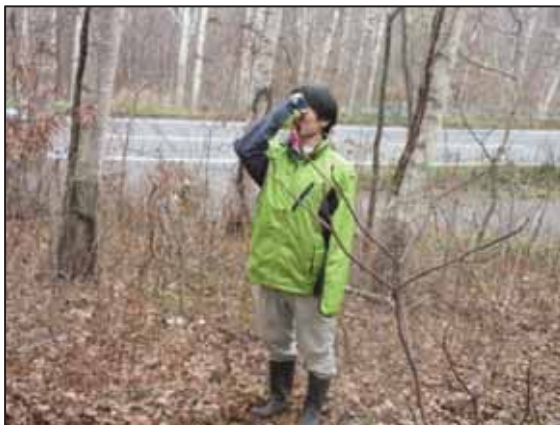
【写真】バーテックス5を操作し樹高を測定する
