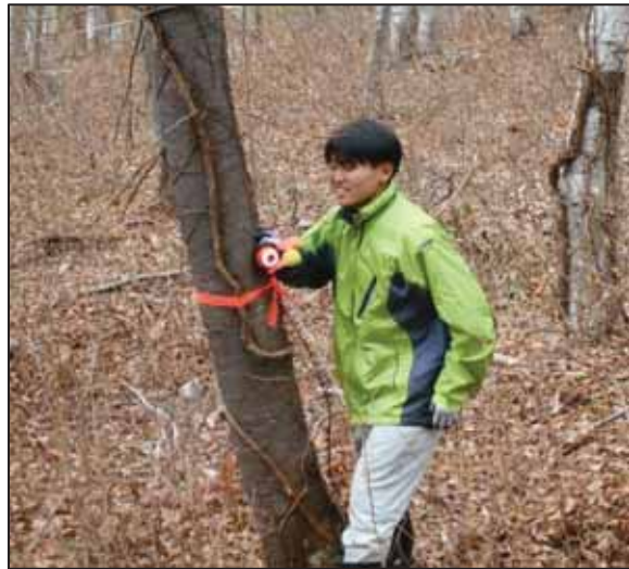
【写真】計測対象立木にトランスポンダー（超音波測定のためターゲット）を設置
