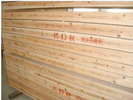
写真7-3 スギKD(人工乾燥)柱材
