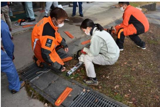
水準器でチェーンソーの水平を確認
