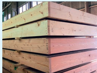
写真8-2 パネル化された2×10材
