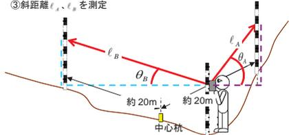
④角度、斜距離を計算式に代入し、最大傾斜を求める
