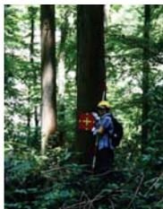
ることを防ぐため、必ず測定対象立木に反射器を設置する。
