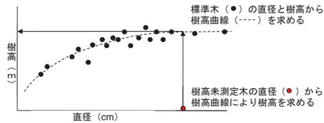
標準木は、以下の基準により選定する。ただし、調査精度の向上を図る観点から、20本を超えて樹高測定することを妨げるものではない。
