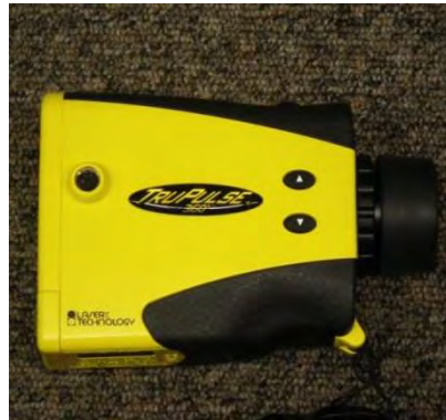
レーザー測高器 1 : トゥルーパルス (右は、自作の反射板)
