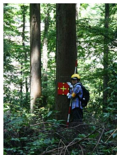
ることを防ぐため、必ず測定対象立木に反射器を設置する。
