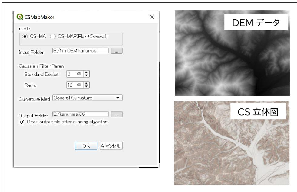
図 2-12 CS 立体図「CSMapMaker」のパラメータ設定
