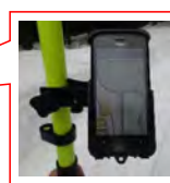
GNSSレシーバ等を活用した端末に境界情報を入力し、杭打ち作業に活用
