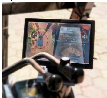
図 3-21 VIA Mobile360 AI フォークリフト安全キット
