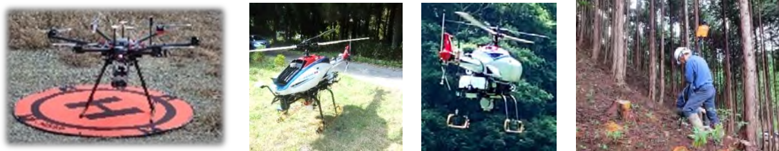
図 4-9 立木在庫の見える化のため使用した無人航空機 (UAV)・地上レーザ計測機
