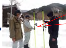
GNSSレシーバ等を活用した端末に境界情報を入力し、杭打ち作業に活用
