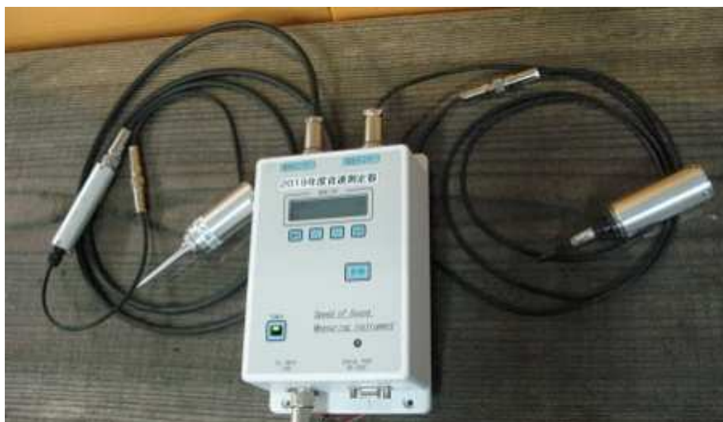
図 3-22 小型化した音速測定装置
