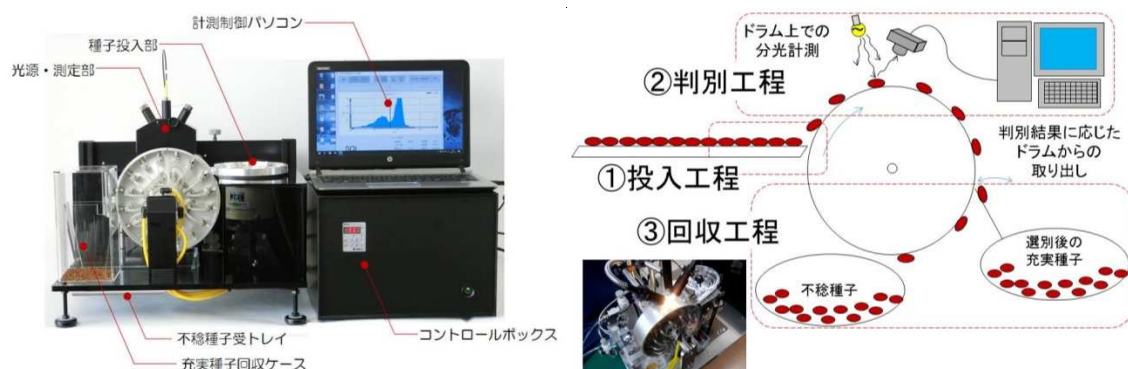
図 3-8 開発時の充実種子選別装置（「新しいコンテナ苗生産方法の提案」より引用） （左図）と種子選別機の概念図（右図）
