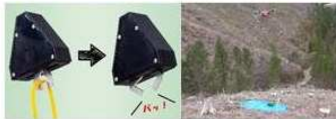
図 3-12 専用フックと苗木離脱の様子
