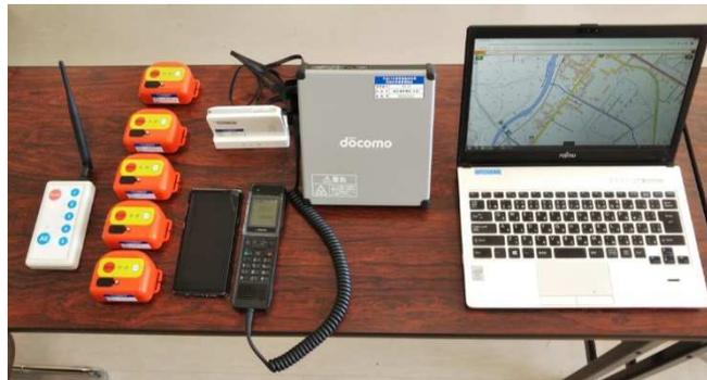
にぶつかるなど強い衝撃を受けた場合に、LPWA（本装置では無線免許が不要な LoRaWAN 規格を採用）を利用して自動的に親機及び他の子機に緊急通報を行う。チェンソー使用などの騒音環境下でも感知できるよう、子機が発生する音と振動（キツキのようにヘルメットを叩くことが装置名の由来）の両方で通知する。
