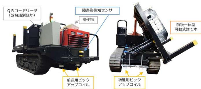
試作機は自動荷おろし機構（荷台を傾けて盤台に下ろす）、自動走行機構（電磁誘導方式、走行ルートに誘導用の電線敷設が必要）、走行速度調整機構（作業員の運転した速度をコンピュータが記憶）を備えている。QRコードにより、自動走行開始位置、停止位置、スイッチバックの分岐点、などを認識する。
