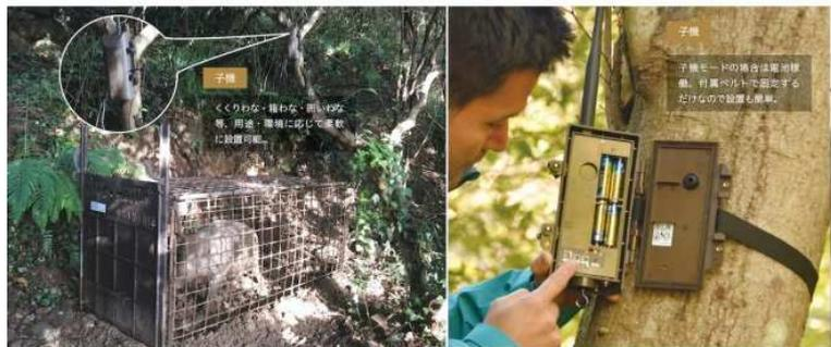
。「オリワナシステム」は独自通信規格（陸上移動無線局）を利用した捕獲通知システムである。
