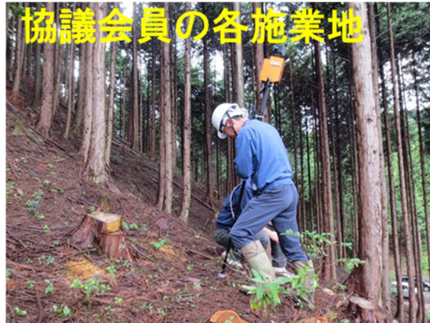
図 2.19 地上レーザ「OWL」での計測実施状況
