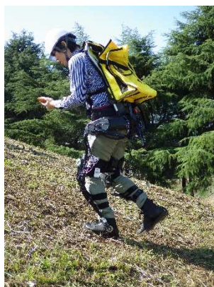
図 3.1 林業用アシストスーツ（試作機）の歩行試験
