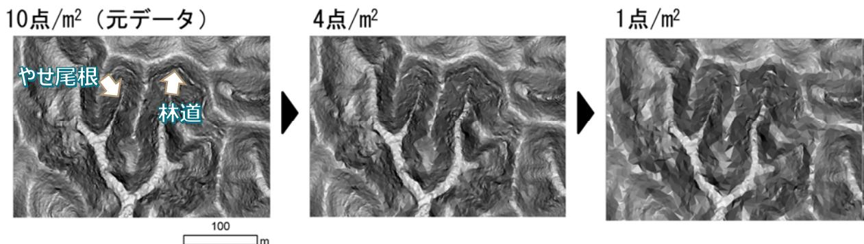
注) 10 点/ $m^2$  の LiDAR データをもとに 4 点、1 点に間引いて作成
