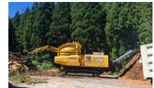
（移動式破砕チップパーによる中間土場での枝条チップ化）
