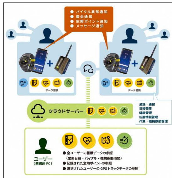
制作したウェアラブル端末のプロトタイプの詳細とその仕組み
