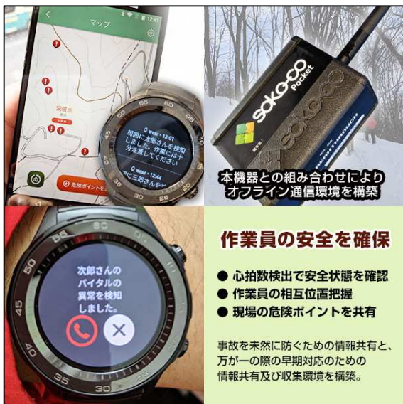
制作したウェアラブル端末のプロトタイプの詳細とその仕組み
