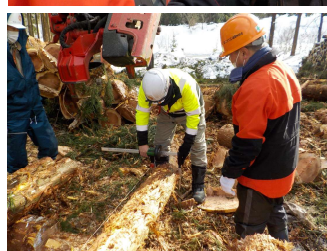
図3 新しい技術の導入の検討 (上)ICT機能を活用し丸太の生産状況を確認 (下)ICTハーベスタの計測精度を確認
