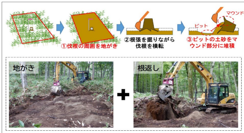
図2 地がき、根返しの作業手順
