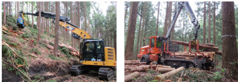
（ロングリーチハーベスタ：伐倒・造材） （フォワーダ：積込み・運搬）
