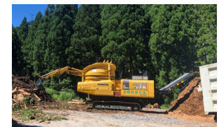
（移動式破碎チッパーによる 中間土場での枝条チップ化）
