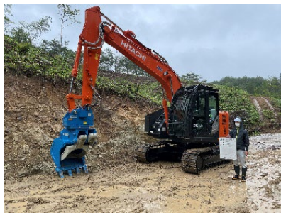
（導入した中古の油圧ショベルとフェラーバンチャハイブリッドバケット）
