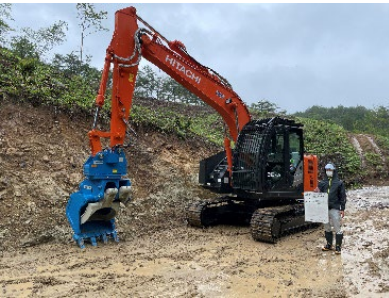
（導入した中古の油圧ショベルとフェラーバンチャハイブリッドバケット）
