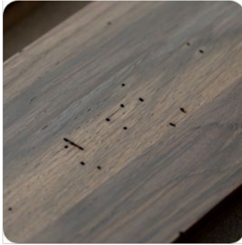
ナラ枯れ材の家具（アパレルブランドファクトリエとカリモク家具の連携商品） ナラ枯れによる虫食い跡のある材を活用し、里山放置の課題と関連付け商品化。虫食いへの防衛のため生成されるタンニンが鉄媒染に反応し、様々な色合いに変化（写真はファクトリエ HP より）
