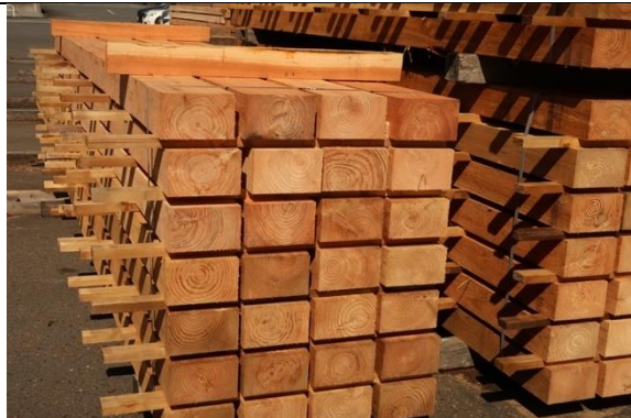
写真5 大径木から製材された 105x150 角材
